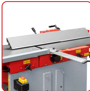
arresto per pialla a filo inclinabile (90-45°) tiltable planer fence (90-45°)
