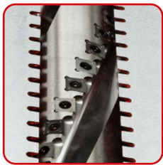
HOB410PROSMW4: präzisionsgelagerte Spiral-Messerho- belwelle mit Wendeschneidplatten (4 Rillen a 17 Stück) precisely bedded spiral cutter block with in total 68 cutter inserts (4 grooves a 17 cutter inserts)
